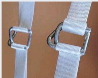
Le cinghie “UNIDIREZIONALI COMPOSITE” vengono realizzate inserendo in una matrice plastica delle micro matassine di poliestere. Il risultato è una cinghia COMPATTA, ELASTICA che offre buona resistenza alla ABRASIONE ed un ELEVATO CARICO di ROTTURA (sino a 2200 daN)
