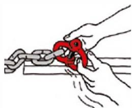
Una volta assemblata la maglia di giunzione, verificare che le due mezze maglie si possano muovere liberamente.
