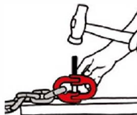
Una volta inserito completamente il perno, esso non dovrebbe potere essere estratto facilmente. Controllate il buon serraggio della spina elastica.
