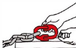
La giunzione non è progettata per frequenti montaggi e smontaggi. Posizionate la spina elastica di sicurezza con leggeri colpi di martello all'estremità del perno.
