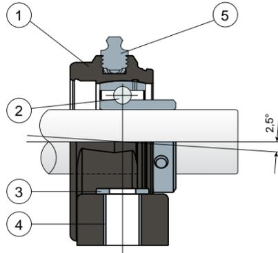
Fissaggio con collare eccentrico
