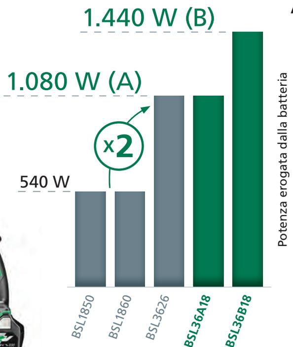
I prodotti 36 V Multi Volt sono dotati di speciali batterie ad elevato contenuto energetico, tali da permettere ad un utensile cordless di affrontare lavorazioni molto gravose che prima potevi realizzare esclusivamente con utensili alimentati a filo.
