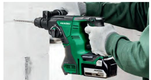
**Applicazioni:** potente e pratico da usare per qualsiasi tipo di foro grazie all'alta efficienza del dispositivo di percussione. Alta capacità di perforazione fino ad un massimo di 27 mm nel legno, 13 mm nell'acciaio e 26 mm nel calcestruzzo o 50 mm con punta corona. Ideale con l'apposito estrattore polveri codice HTA402933.
